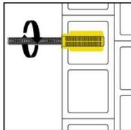
Inserte el anclaje, lentamente con un ligero movimiento de torsión del tamiz.
